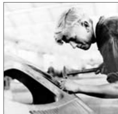
Ausbildung im Vorwerk an der Karosserie eines Käfers. Gut zu sehen: Brezelfenster und die Schlitz zur Motor-entlüftung. Fotos: Archiv Schrimpf
